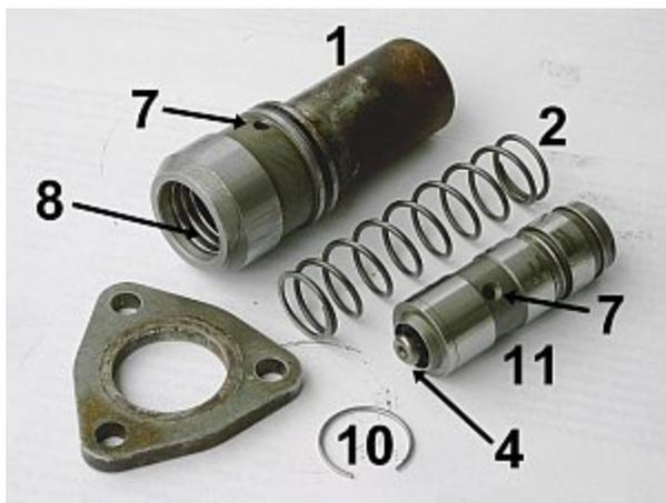
Il y a un risque avec le tendeur de chaîne à réglage automatique qu'il se rétracte complètement si l'anneau indiqué au numéro 10 sur l'image s'use ou se cisaille. Cela peut arriver avec un kilométrage inférieur à 50 000 km. Ceci est particulièrement dangereux à des kilométrages plus élevés, lorsqu'une chaîne tendue entraîne un tendeur de chaîne déjà largement tendu, car la chaîne saute si l'anneau défectueux ne limite pas sa course vers l'arrière. Résultat : dégâts importants au moteur
