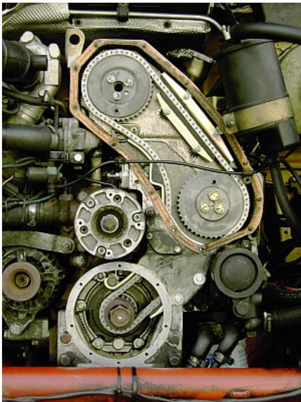
boîte de chaîne de distribution complètement vidée, vous pouvez voir les alésages du boîtier au-dessus du bout d'arbre à cames et en dessous de l'arbre de la pompe d'injection, à l'aide desquels les engrenages correspondants peuvent être amenés dans la position de base et fixés lors de l'installation de la chaîne (flèche rouge) .
