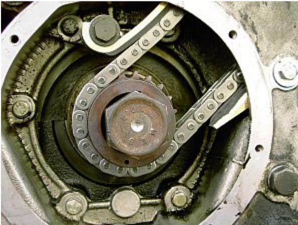
Il faut d'abord un outil adapté : la couronne dentée du vilebrequin est frettée et ne peut être retirée qu'avec un "extracteur hydraulique", ici improvisé à partir d'un cric 5t, d'une plaque de base, de deux bras réglables et d'une sorte de collier de serrage, qui se trouve derrière les rangées de dents autour des griffes de la couronne.
