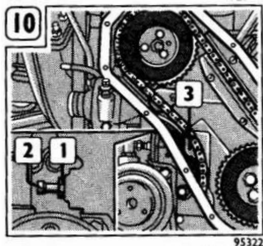
Dans l'ancienne version, le jeu **entre la chaîne et la glissière mobile** (3) est réglé à sec à 0,4-0,7 mm (jauge d'épaisseur) à l'aide de la vis de réglage (2), fixez la position avec le contre-écrou (1).
